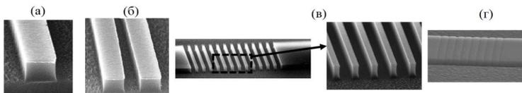
Рис. 1. Изображения микроструктур, полученные с помощью электронного микроскопа: (а)- область связи микрокольцевого резонатора и микроволновода; (б) - выходного элемента связи периодического типа (в), входного элемента связи периодического типа, закрытого осажденным слоем (г)
