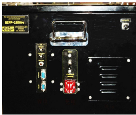
в) U_{\text{ном}}=25,5\text{В} , C=180\text{А}\cdot\text{ч} , I=100\text{А}
