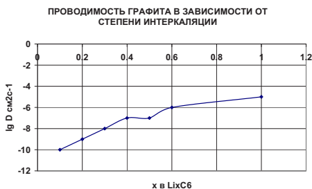
Рис. 4. Проводимость графита в зависимости от степени заполнения решетки (степени интеркаляции, величины x в \text{Li}_x\text{C}_6 ).
