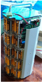
а) U_{\text{ном}}=22\text{В} , C=198\text{А}\cdot\text{ч} , E=210\text{Вт}\cdot\text{ч}/\text{кг}
