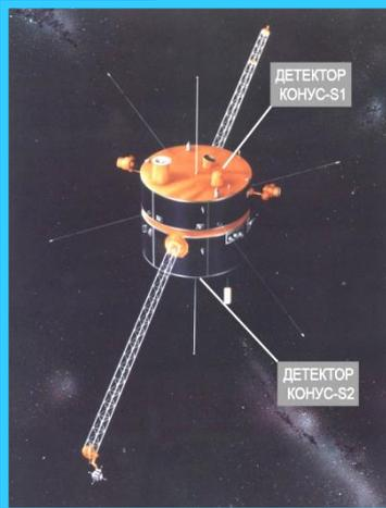
Аппаратура «Конус» на КА НАСА «Винд»
