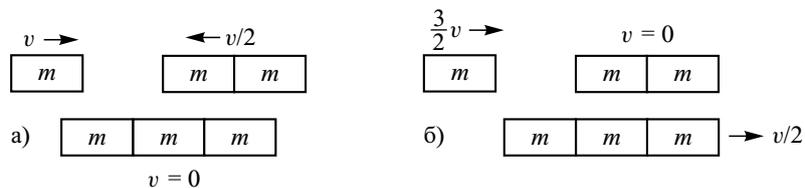
**Рис. 6.9.** а) Неупругое столкновение двух тел с массами  $m$  и  $2m$ . б) То же самое, но в системе отсчета, в которой тело массы  $2m$  покоится.
