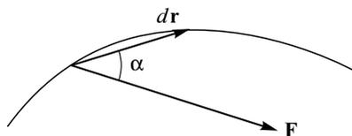
Рис. 7.1. Работа равна скалярному произведению силы на перемещение.
