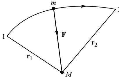
**Рис. 7.7.** Работа силы гравитационного притяжения двух точечных масс.
