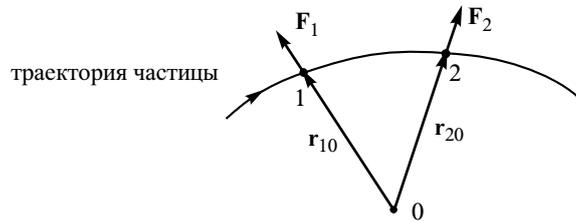
**Рис. 7.5.** Точка 0 — силовой центр. Силы  $F_1(r_{10})$  и  $F_2(r_{20})$  зависят только от расстояния до центра. гравитационного притяжения Земли к Солнцу (или Луны к Земле). Для того чтобы рис. 7.5 соответствовал этому случаю, надо только изменить направления сил на рисунке на противоположные, так как там они изображены как силы отталкивания.
