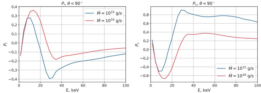
Рис. 2. Слева — степень линейной поляризации в зависимости от энергии фотона; справа — степень круговой поляризации. Результаты усреднены по углам  $\theta < 90^\circ$ . Параметры:  $M = 1.4M_\odot$ ,  $R = 12$  км,  $R_c = 1$  км,  $E_{\text{сус}} = 20$  кэВ
