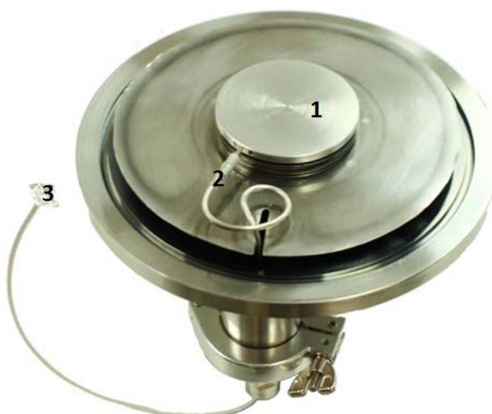
Рисунок 2.5.3. Фотография экспериментальной установки по исследованию параметров плазмы ВЧ разряда с заземленным ВЧ электродом. К круглому ВЧ-электроду (1) присоединён коаксиальный кабель с минеральной изоляцией (3), который был присоединен с атмосферной стороны к коаксиальному кабелю с полиэтиленовой изоляцией. Суммарная длина кабелей составляла  $\lambda/4$ .
