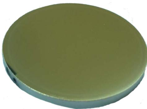
Рисунок 3.3.1. Молибденовое зеркало, использовавшееся в экспериментах по исследованию неоднородности очистки в качестве ВЧ электрода, с нанесенной тонкой пленкой золота толщиной ~40 нм
