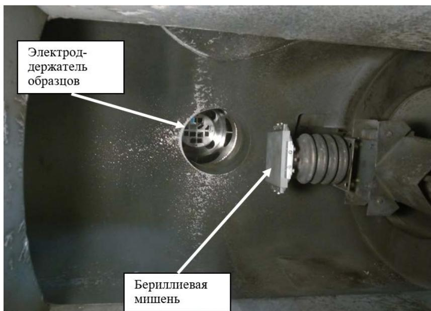
Рисунок 3.4.4. Внешний вид мишенной камера КСПУ-Ве с установленной бериллиевой мишенью
