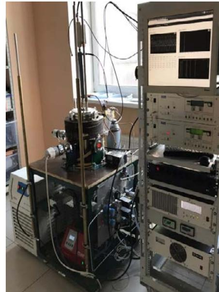
Рисунок 2.1.4. Экспериментальный стенд № 2 с аксиальным магнитным полем на оси, перестраиваемым от 0 до 0,05 Тл. 1 – вакуумная камера из нержавеющей стали, 2 – ВЧ-электрод, 3 – заземленный экран, 4 – кольца под плавающим потенциалом, 5 – заземленный электрод, 6 – катушки магнитного поля
