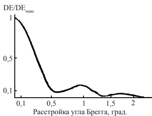
Рис. 2. График характеристики угловой селективности объемной пропускающей голограммы, полученной на ГФПМ (633-1).
