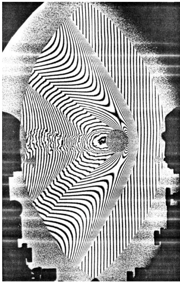
Рис. 17. Интерферограмма обтекания шара в сверхзвуковом полете, полученная на дифракционном интерферометре с увеличенным размером рабочего поля (200 мм). Получена В.А. Комиссаруком и Н.П. Менде*).
