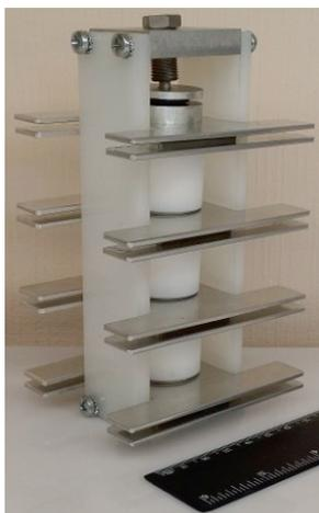
Коммутатор наносекундных импульсов на основе ударно-ионизационных динисторов: рабочее напряжение 24 кВ, ток в импульсе 5 кА, длительность импульса 200 нс, рабочая частота 100 Гц.
