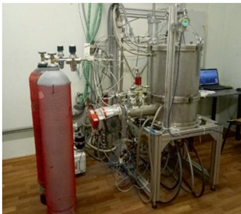
Рис. 1. Установка по выращиванию кристаллов карбида кремния.
