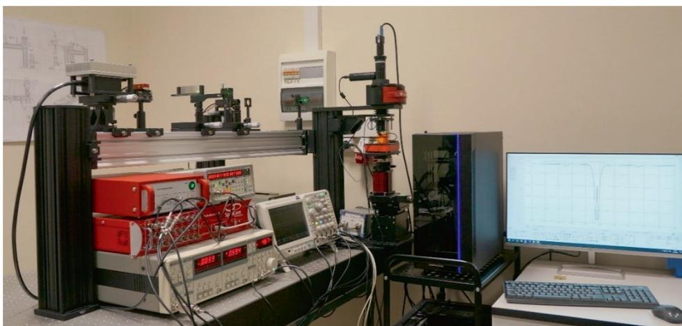
Рис. 1. Экспериментальный стенд ОДМР для контроля за созданием и для исследования уникальных свойств NV-центров в алмазных пластинах.
