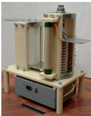
Коммутатор микросекундных импульсов на основе разработанного в ФТИ рекордно-мощного импульсного полупроводникового ключа микросекундного диапазона – реверсивно-включаемого динистора: рабочее напряжение 24 кВ, ток в импульсе 300 кА, длительность импульса 300 мкс.
