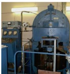
Рис. 1. Гидравлический пресс усилием 1000 тонн-силы для синтеза сверхтвердых материалов.
