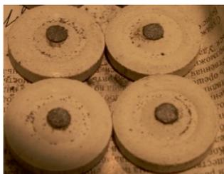
Рис. 2. Контейнер для камеры типа «тороид» из карбоната кальция, в котором происходит синтез алмазов.
