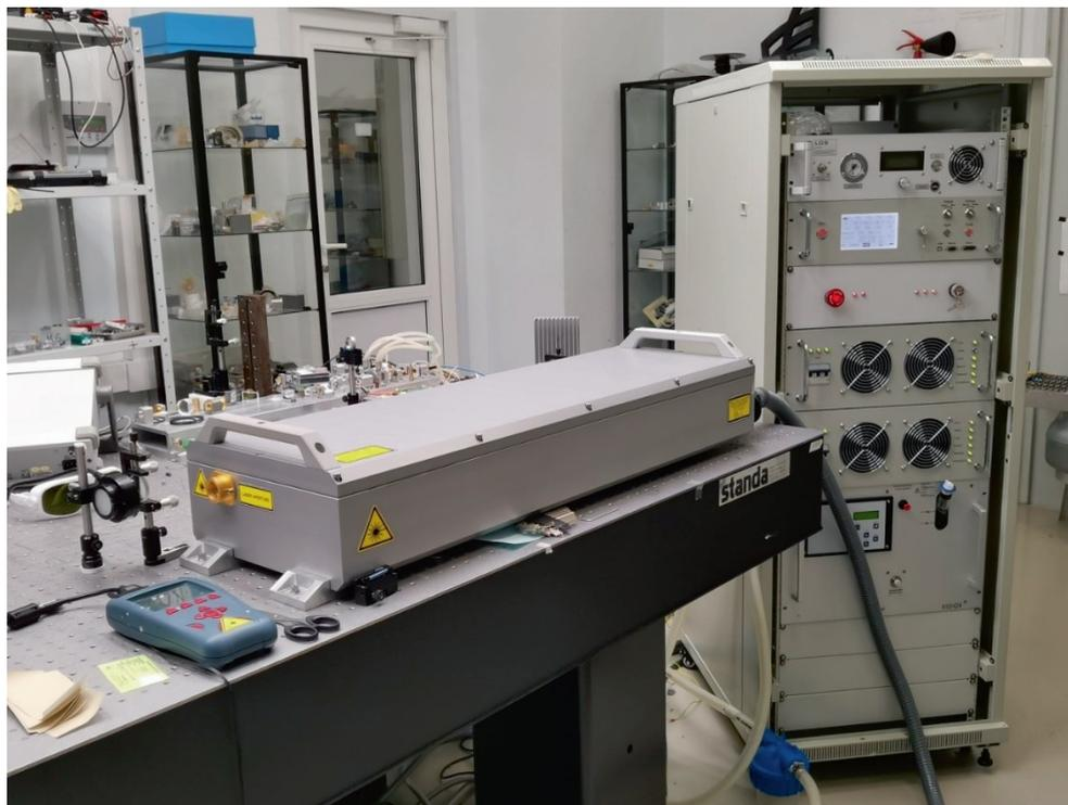
Рис. 7. Прототип лазера Nd:YLF с длиной волны генерации 1047 нм.
