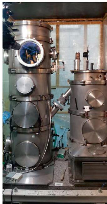
Рис. 2. Фотография установки. Слева – вакуумная камера (устройства внутри нее см. на Рис. 1). Лазерный луч вводится через левый патрубок. Измеритель энергии (поз. (11) на Рис. 1) снят, на правом патрубке установлен рассеивающий экран. Справа на столе – набор поглощающих оптических фильтров и линза, переносящая ИК изображение на экране на ПЗС матрицу (на снимке отсутствует).
