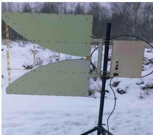
Генератор наносекундных импульсов со сверхширокополосной антенной: амплитуда 50 кВ, длительность фронта 0.4 нс, ширина импульса 1 нс, частота повторения до 1 кГц.
