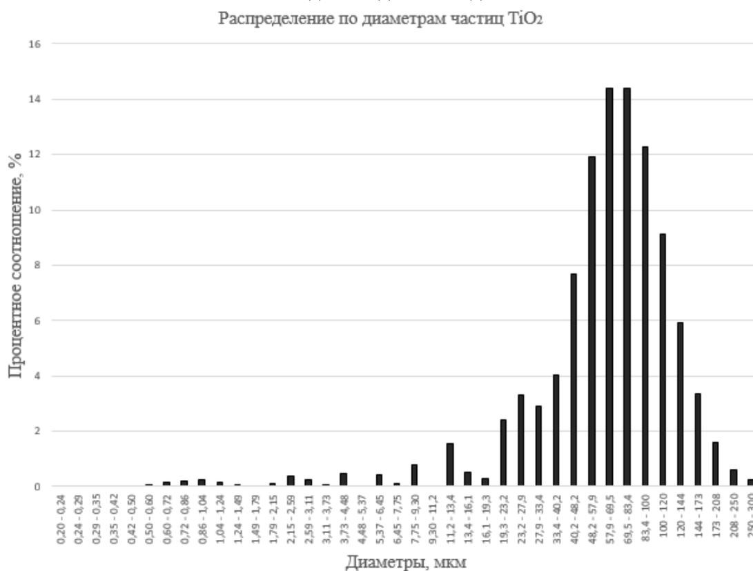
Рис. 9. Гистограмма распределения по диаметрам сферических частиц TiO<sub>2</sub> получаемых методом жидкого анода.
