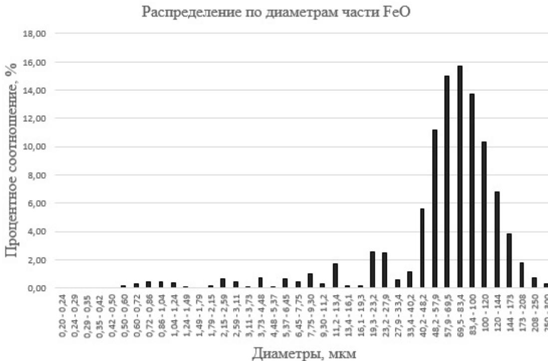
Рис. 8. Гистограмма распределения по диаметрам сферических частиц FeO получаемых методом жидкого анода.
