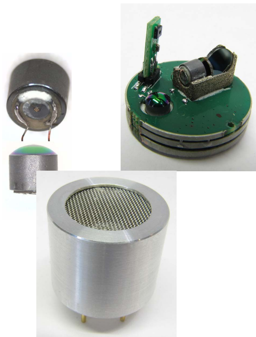
Рис. 23. Фотография использованных иммерсионных свето- и фотодиодов и фотографии разработанного датчика: без корпуса и оптики и полностью собранного.
