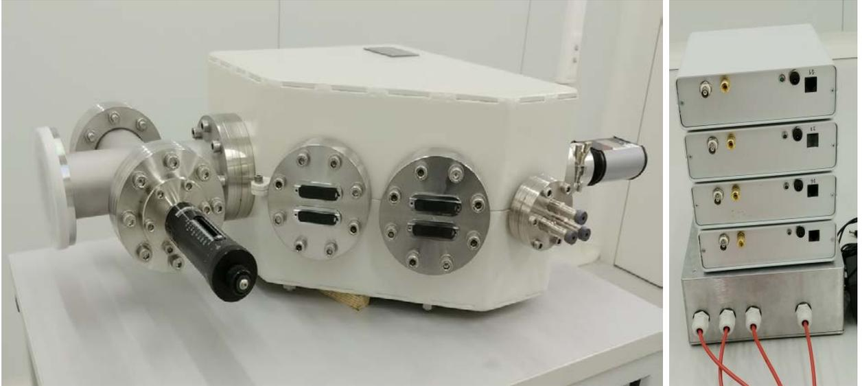
*Рис. 2.1.2. Анализатор CNPA-09 и аппаратура для измерения и управления. Слева – общий вид анализатора с узлом подвижной диафрагмы, справа – высоковольтный и счетные модули*
