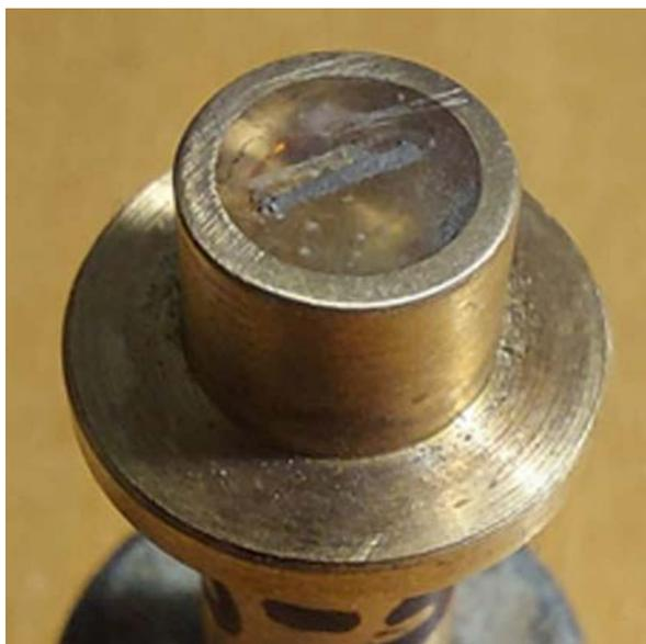
Рисунок 2 Вставка с датчиком теплового потока на анизотропном термоэлементе из монокристалла висмута.
