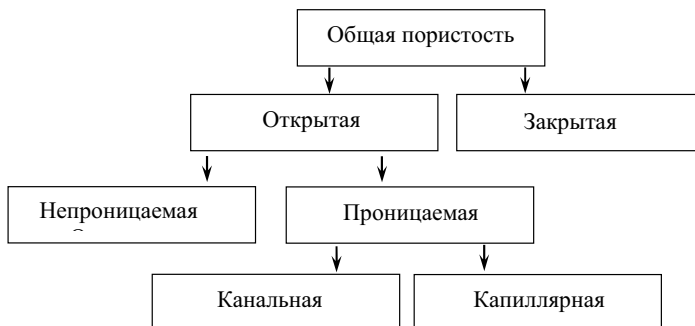
Рисунок 2 – Общая классификация пористости по принципу проницаемости
