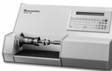
Рисунок 23 – Внешний вид анализатора плотности GeoPyc 1360
