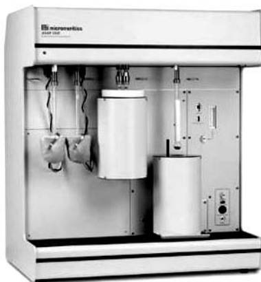
Рисунок 19 – Внешний вид анализатора ASAP 2020
