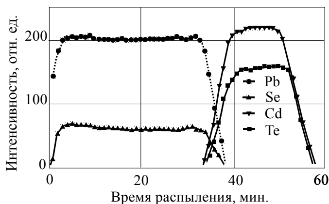
Рис. 3.1. Профиль распределения элементов в пленке после нанесения механической смеси PbSe + CdTe
