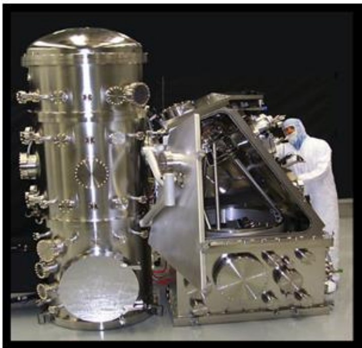
Рис. 18. Внешний вид опытного ЭУФ нанолитографа, изготовленного в США (2001 г).
