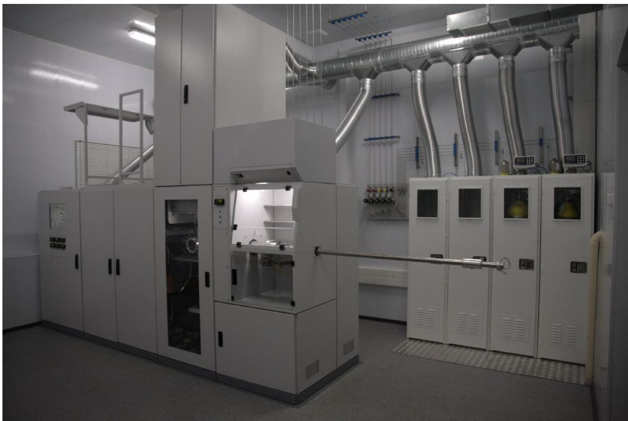
Рис. 1: Реактор для выращивания слоев нитрида галлия методом хлорид-гидридной газофазной эпитаксии.
