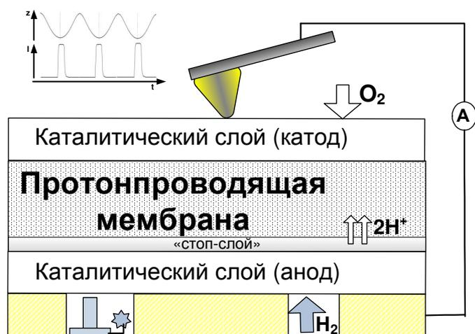
Рис. 1 Схема ПМСР-исследования проводимости каталитического слоя при подаче потока  $H_2$ .
