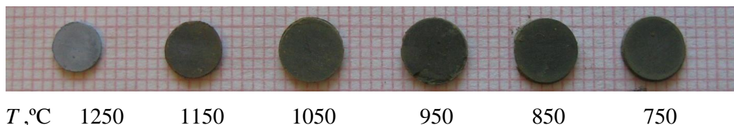
Рис.1. Фотография образцов после отжига в диапазоне температур T = 750 - 1250 °C
