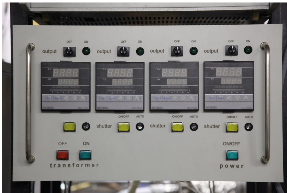
Рис. 2.5 Блок управления установкой МЛЭ
