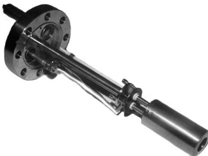
Рис. 2.3 Вид молекулярного источника, использовавшегося в данной работе
