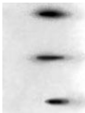
Рис. 5.2 Картина ДБЭ от поверхности слоя \text{CdF}_2 толщиной 200 нанометров, выращенного на низкотемпературном буферном слое
