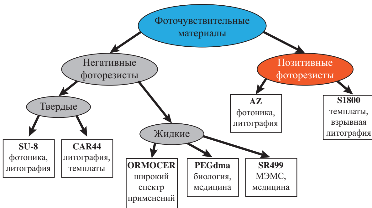
Рис. 2.12. Фоточувствительные материалы, используемые в 3D-ЛЛ и области их применения.
