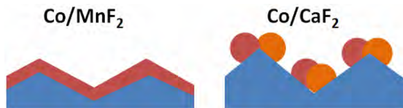
Рис. 105 Предположительное схематическое изображение поперечного сечения гетероструктур \text{Co}/\text{MnF}_2(110)/\text{CaF}_2(110)/\text{Si} и \text{Co}/\text{CaF}_2(110)/\text{Si}(001)
