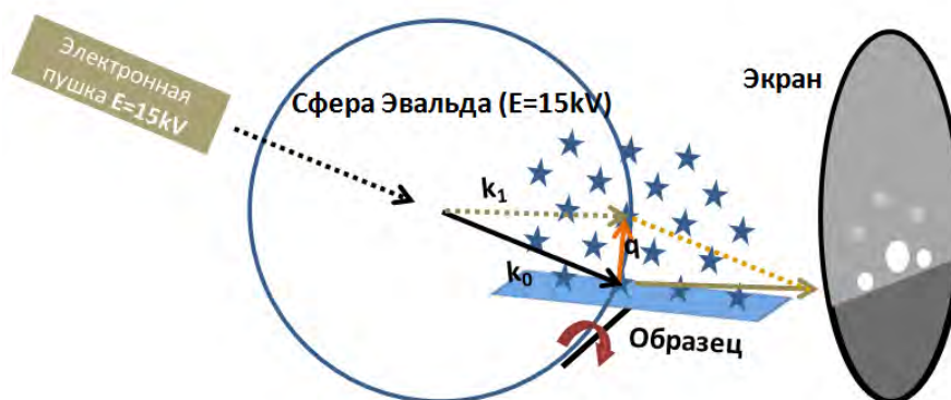
Рис. 28 Геометрия дифрактометра быстрых электронов [279]; построение сферы Эвальда.
