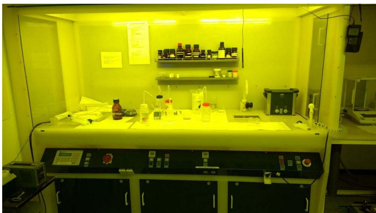
Рис. 2.1. Установка в чистой комнате для изготовления графена методом «скотча».
