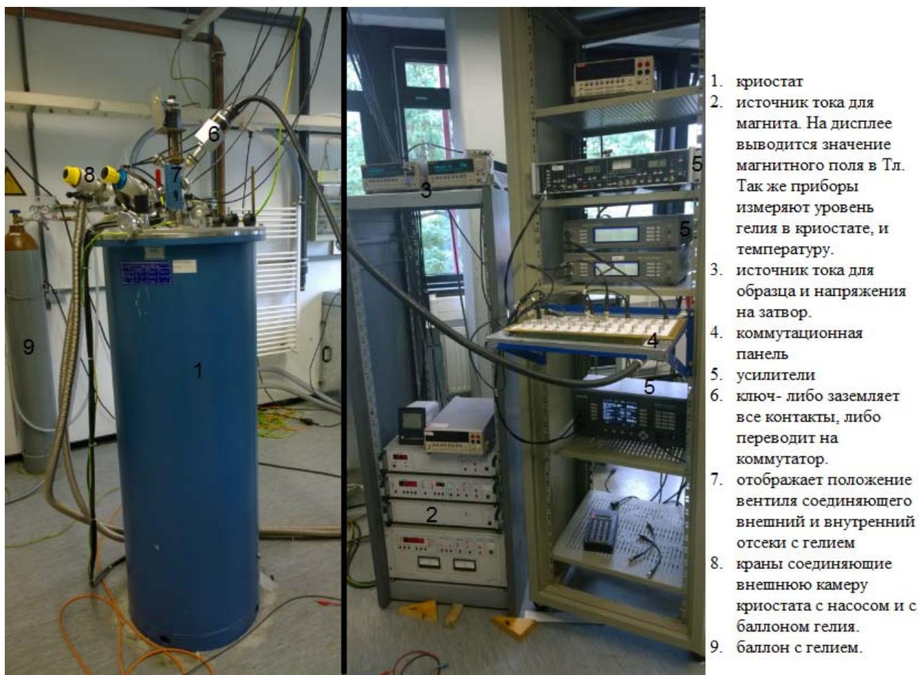
Рис. 2.10. Фотография установки для магнетотранспортных измерений. Список основных составляющих приведен сбоку от рисунка.
