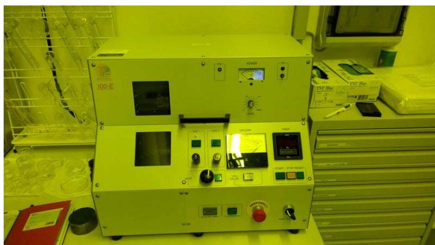
Рис. 2.2. Установка для плазменного травления.
