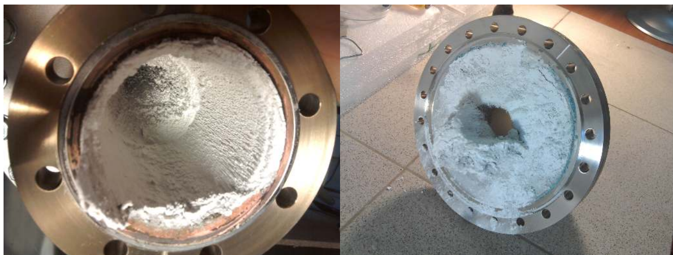
Рис. 12: Отложения хлорида аммония, образовавшиеся в выпускном тракте ХГФЭ реактора в ходе серии ростовых процессов.
