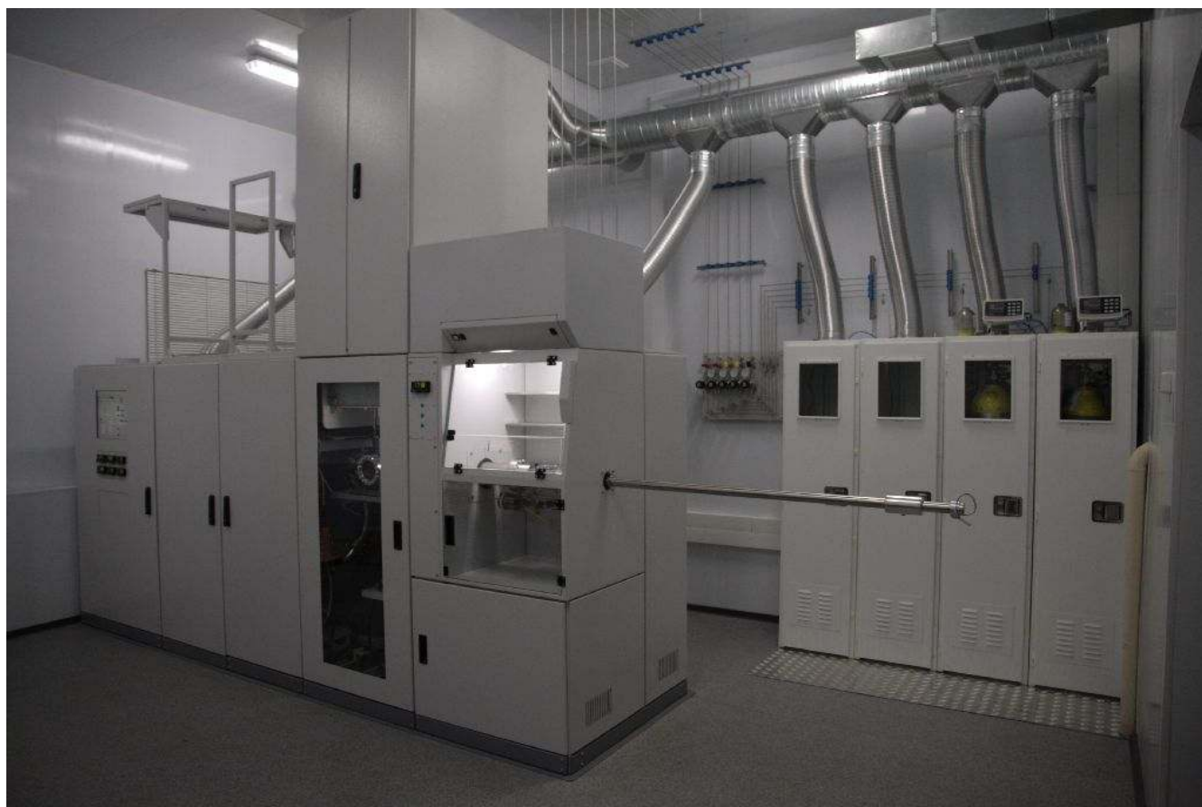
Рис. 1: Ростовая установка для выращивания слоев нитрида галлия методом хлорид-гидридной газофазной эпитаксии.
