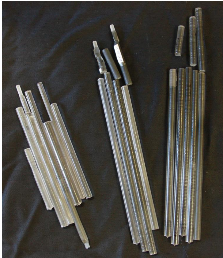
Рис. 9. Кристаллы, выращенные для проведения исследований морфологии боковой поверхности
