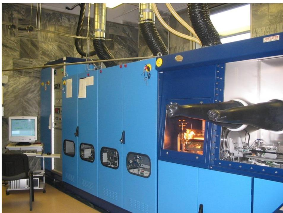
*Рис. 2.1 Внешний вид установки МОС – гидридной эпитаксии AIX200/4 немецкой фирмы AIXTRON*
