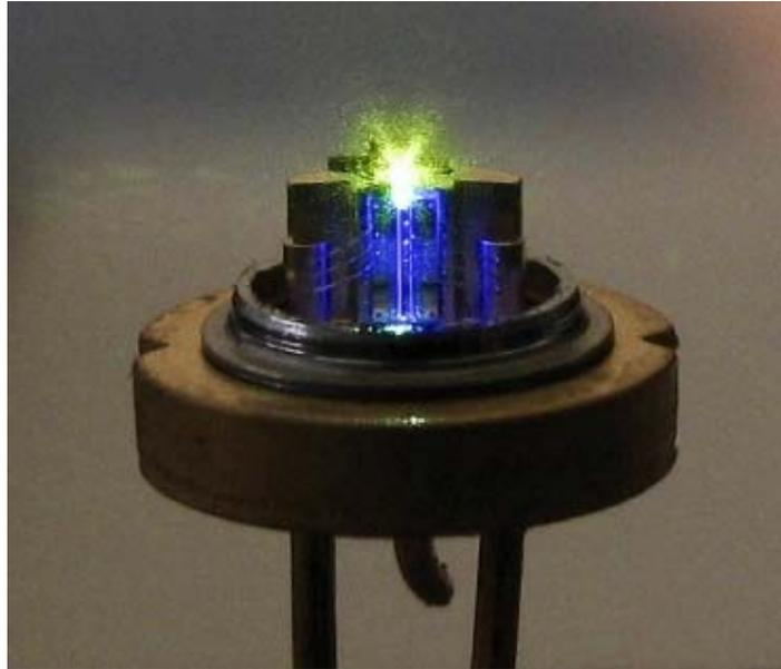
Рисунок 5.11 - Фотография микрочип-конвертера в рабочем режиме.
