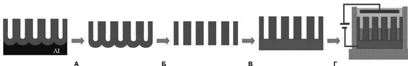
Рисунок 1.18 — Изготовление металлических нанопроводов с использованием отделенной нанопористой пленки АОА. А - удаление подложки Al (алюминий может быть селективно удален с помощью водных растворов HgCl_2 , CuCl_2 : HCl или SnCl_4 при комнатной температуре). Б - удаление барьерного слоя с помощью \sim 5\% раствора H_3PO_4 при 35\text{ }^\circ C . В - металлизация. Г - заполнение металлом [135].
