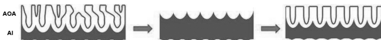
Рисунок 1.17 — Схематическое изображение двухстадийного процесса анодирования Al . Слева направо: плёнка АОА после первой стадии анодирования; удаление пористой плёнки; плёнка АОА после второй стадии анодирования [135].
