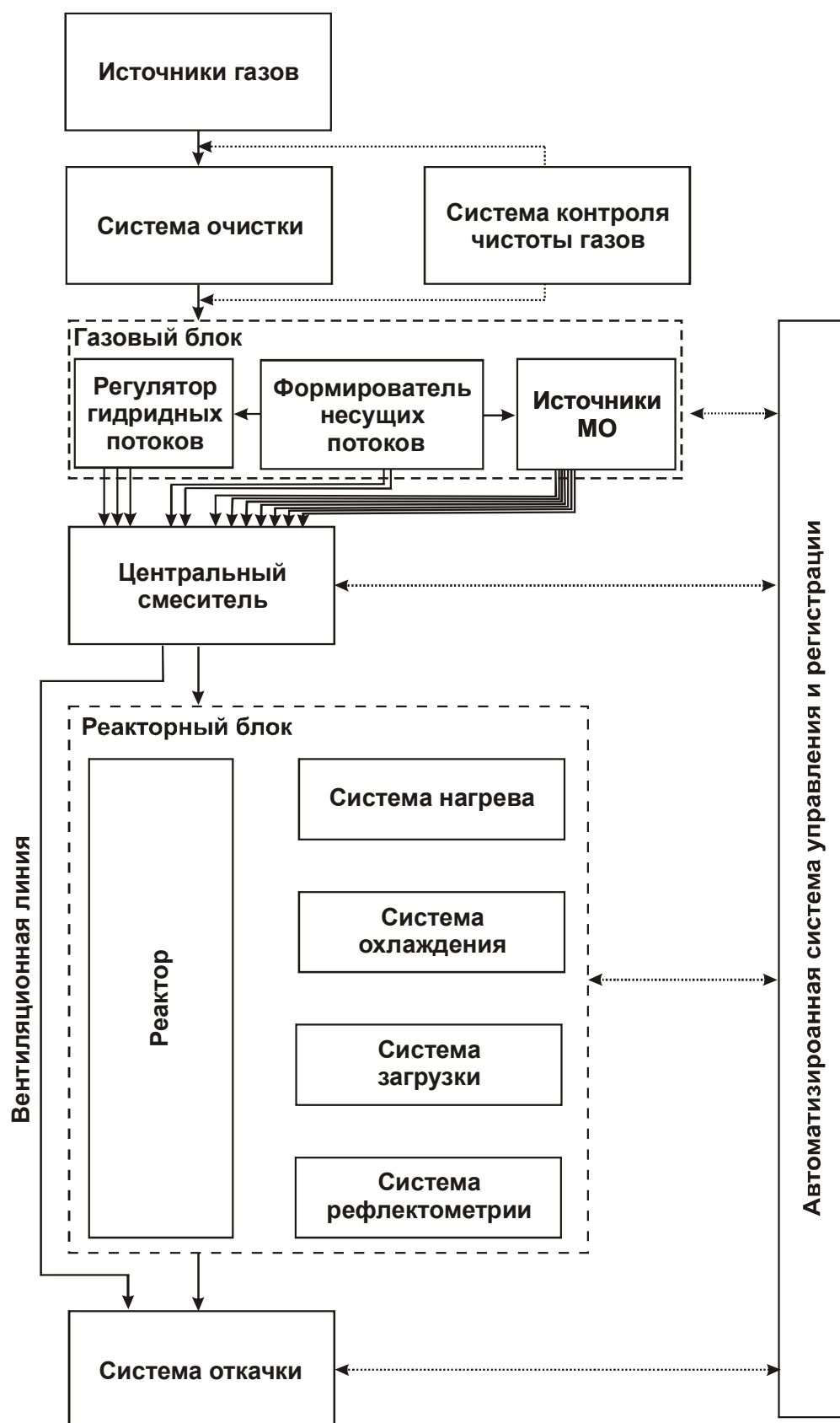
Рис. 2.1. Блок-схема лабораторной установки ГФЭ МОС Eriqur VP-50 RP [44, 184].
