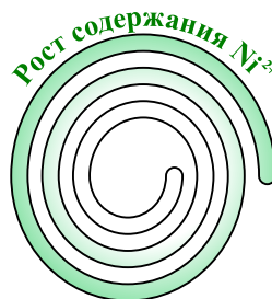
Рисунок 3.15 – Иллюстрация распределения изоморфной примеси Ni^{2+} в наносвитке хризотила переменного состава (Mg,Ni)_3Si_2O_5(OH)_4 (доля Ni^{2+} растёт с увеличением цвета).
