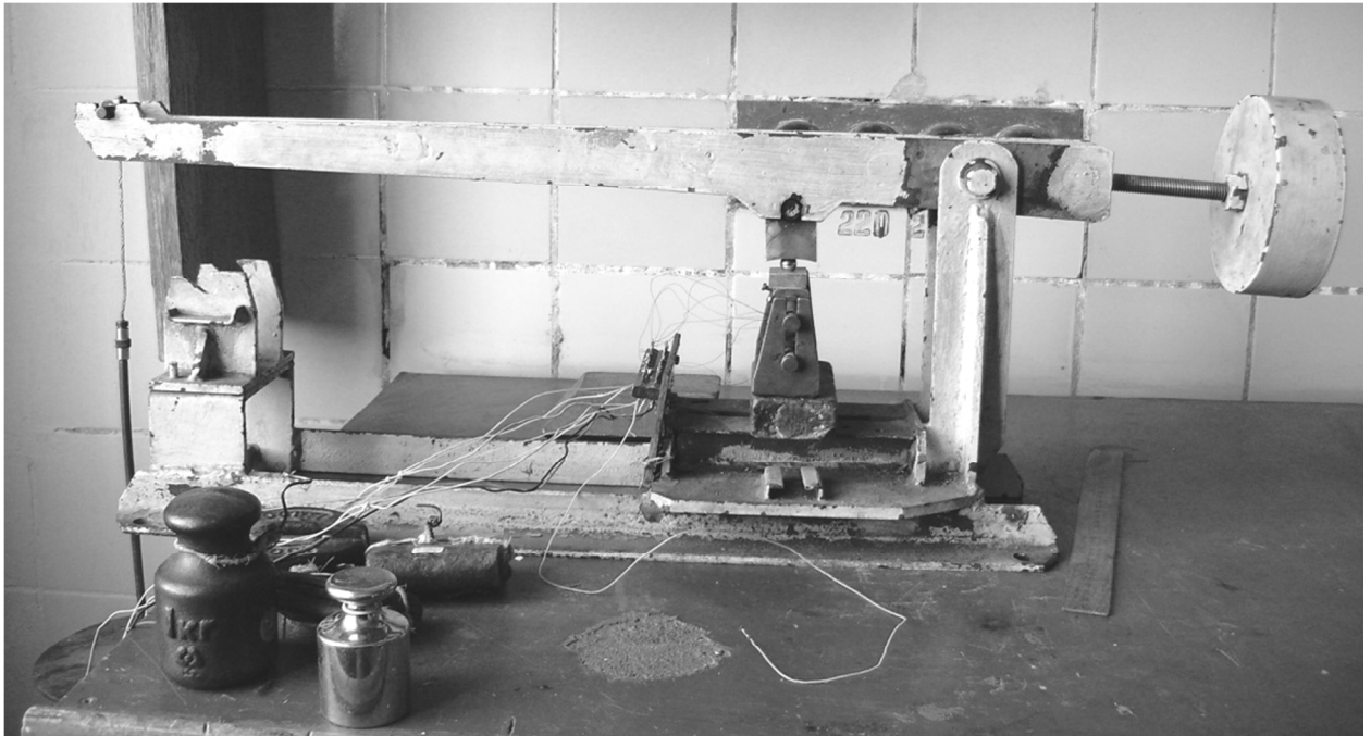
Рис.2.4 Экспериментальная установка по измерению коэффициента тензочувствительности
