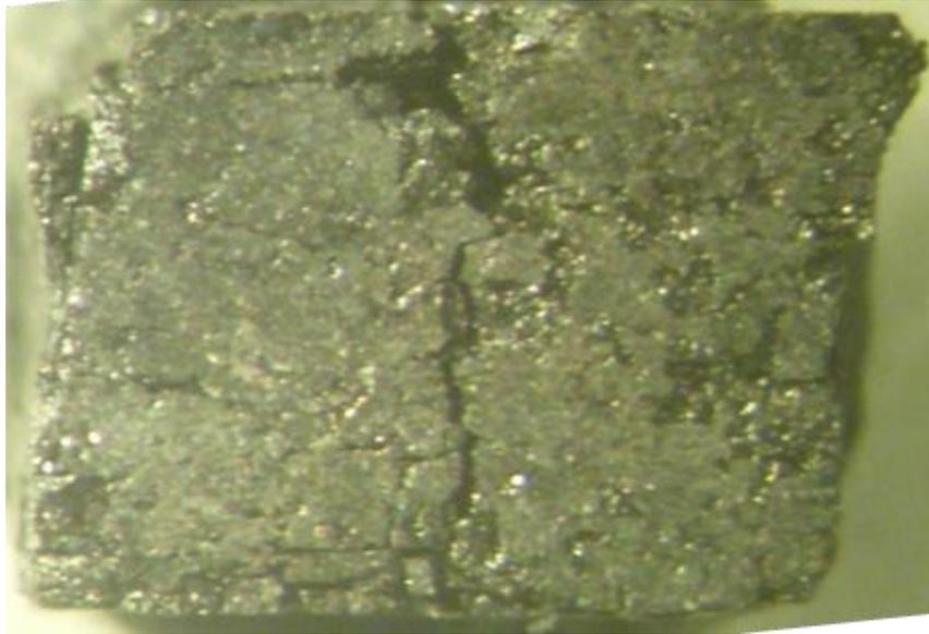
Рис.5.5. Испытуемый образец SmS после девятого цикла нагружения гидростатическим давлением  $P=0.71$  GPa [A34].
