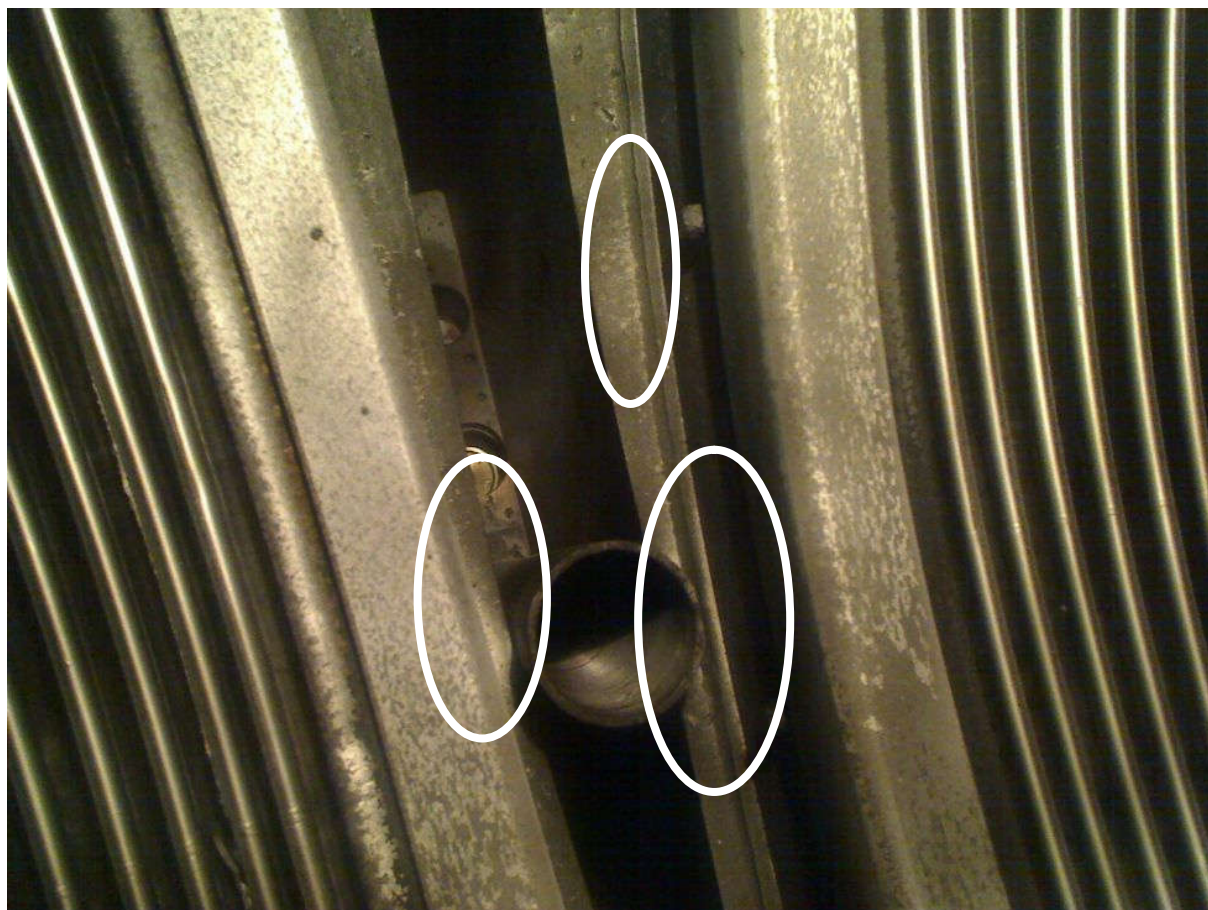
Рис. 4.15. Литиевый порошок в нижней части вакуумной камеры Т-10 в сечении инъекции.
