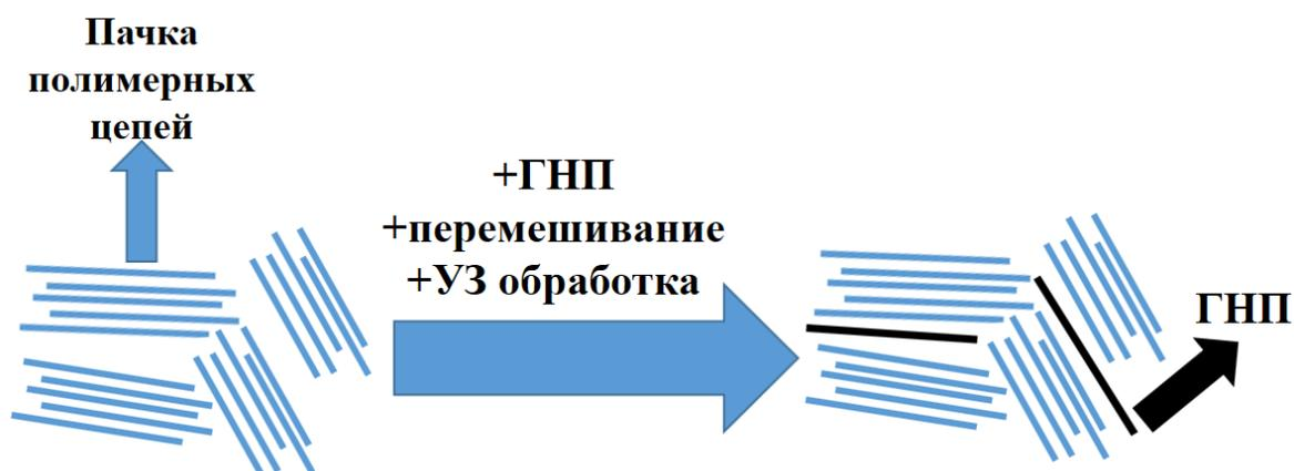
Рисунок 38. Модель распределения ГНП по объему полимерной матрице в КМ
