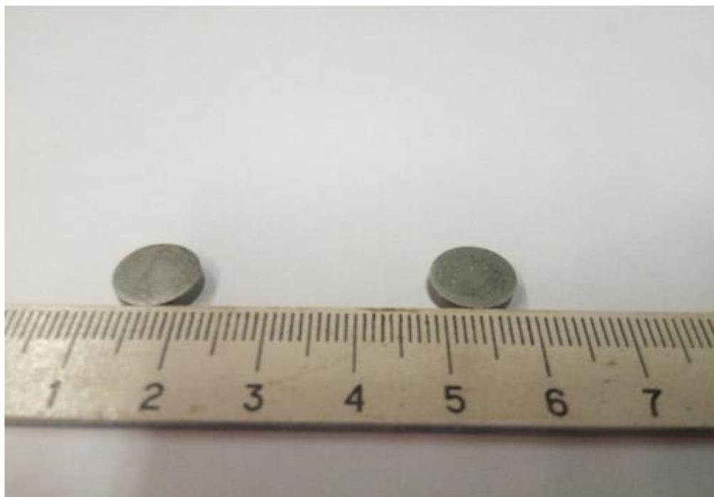
Рисунок 22. Внешний вид образцов ALM после спекания
