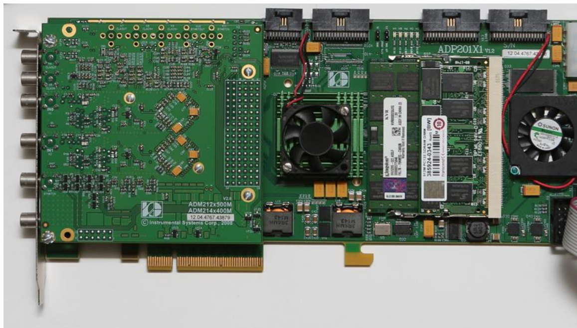
Рисунок 3.14 – Фотография устройства оцифровки сигнала ADP201X/ADM214x400M
