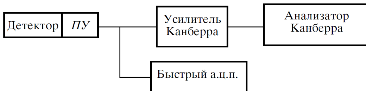
Рисунок 3.10 - Блок схема сравнительных экспериментов с радиоактивными источниками на JET [72]
