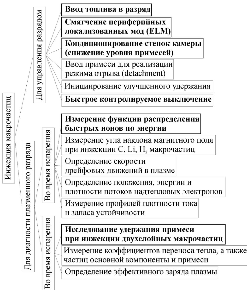
Рис. 1.3 Диаграмма поясняющая возможные способы использования инъекции макрочастиц в установках с магнитным удержанием плазмы. Жирным шрифтом выделены наиболее перспективные направления.
