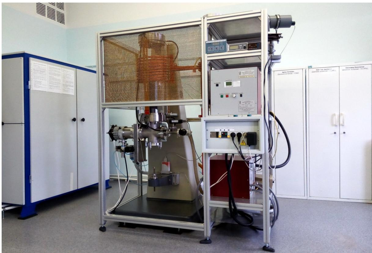
Рисунок 2.2 – Технологическая установка для роста графена на поверхности SiC
