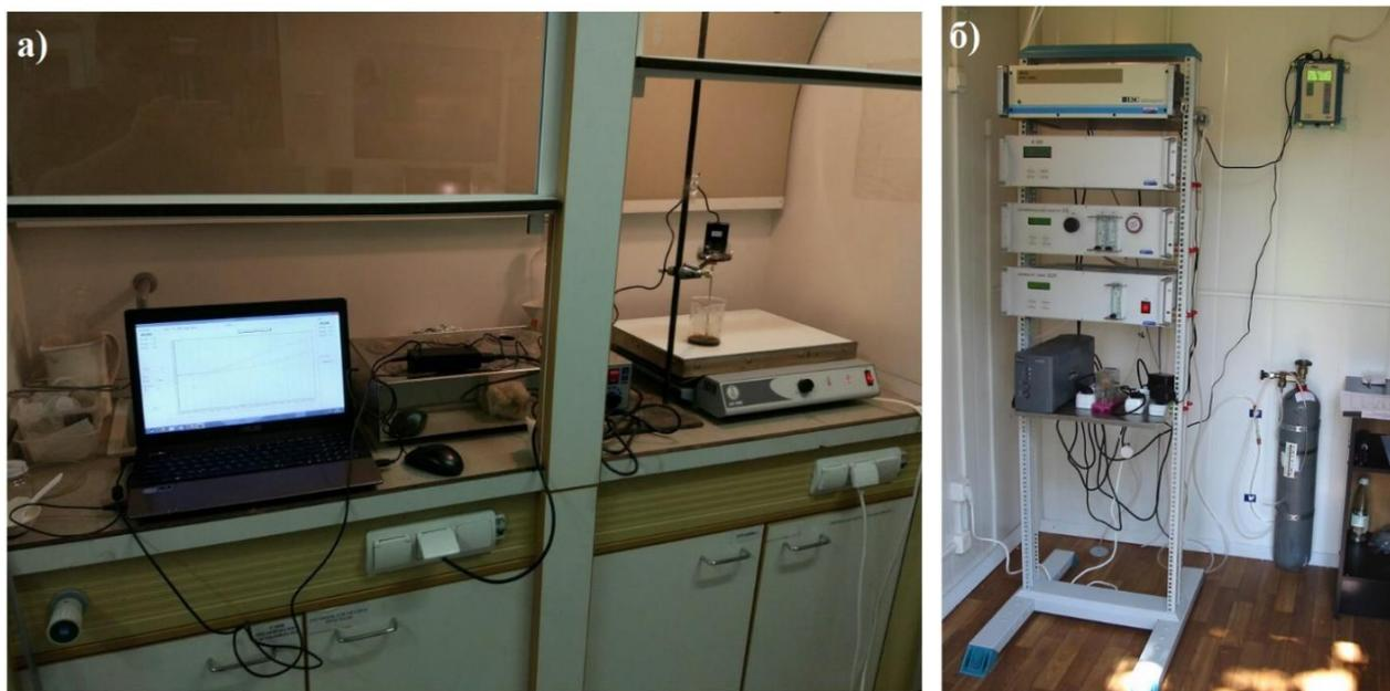
Рисунок 22 – Платина-платинородиевая термопара и датчик «TEMPerIK4» для измерения температуры горения пламени (а) и измерительный комплекс «СКАТ» для анализа газообразных продуктов горения (б)
