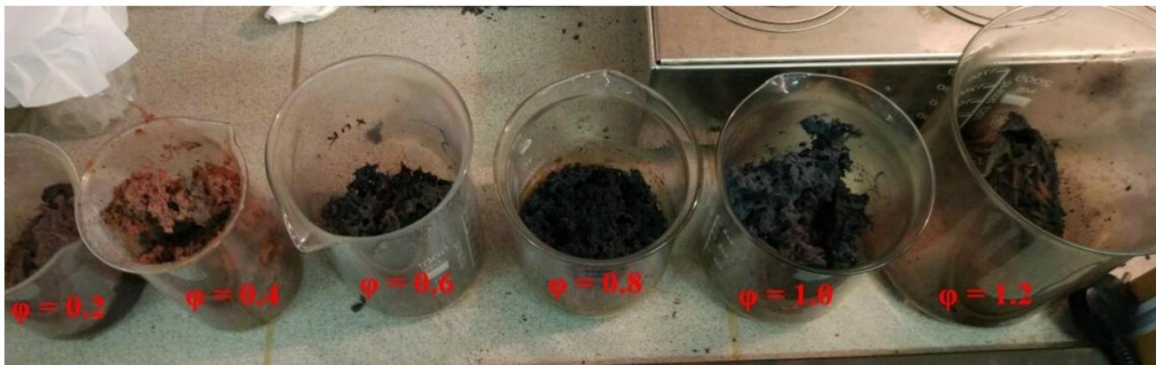
Рисунок 21 – Изменение цвета твердого продукта горения на примере синтеза литий-цинк-марганцевого феррита в условиях растворного горения при различных окислительно-восстановительных соотношениях ( $\varphi$ )
