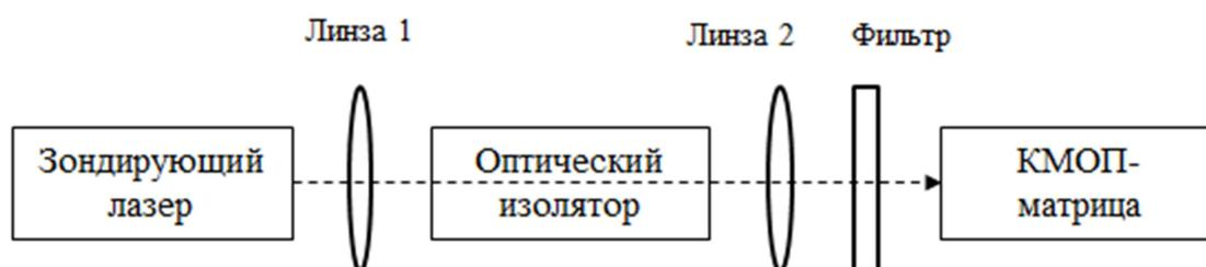
Рисунок 3.4 – Экспериментальная установка исследования пространственных параметров лазерного луча в точке фокусировки
