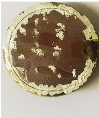
Рис. 2.2. Фотография образцов, подготовленных для исследований электронно-зондовыми методами.
