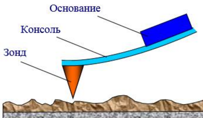
Рисунок 2.1 – Схематическое изображение зондового датчика АСМ [151]
