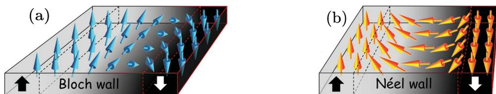
Рисунок 15 — Схематическое изображение доменных стенок (а) Блоха и (б) Нёеля. Стрелки показывают направление намагниченности. Рисунок приведен из [160].
