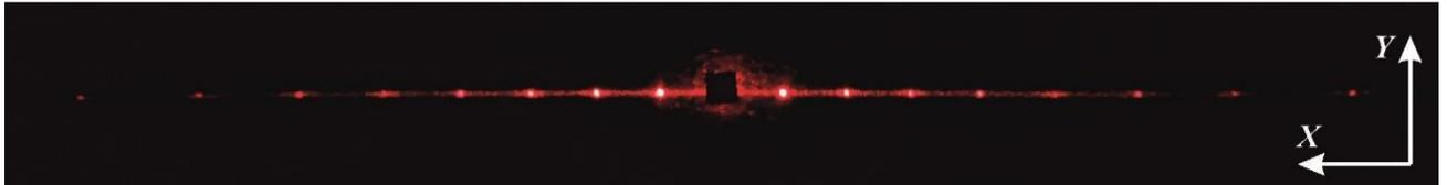
Рисунок 3.2 – Фотография экрана сделана от кристалла в сторону лазера. На фотографии видны отраженные от образца дифракционные максимумы от  $\pm 1$ -го до  $\pm 8$ -го порядков, пришедшие от  $Z$ -границ кристалла  $1\% \text{MgO}:\text{LiTaO}_3$  с РДС при нормальном падении на неё пучка He-Ne лазера с длиной волны  $\lambda = 632,8$  нм, мощностью 22,5 мВт, апертурой 0,7 мм и поляризованного по оси кристалла  $Y$ .
