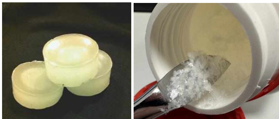
Рис. 1.10. Парафиновый воск слева [143] и монодисперсный н-алкан (тетракозан), имеющий вид хлопьев, справа.
