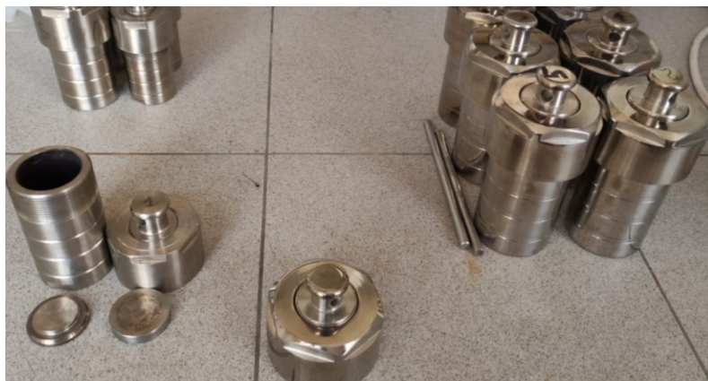
Рисунок 14 – Стальные автоклавы для проведения гидротермальной обработки водно-солевых смесей
