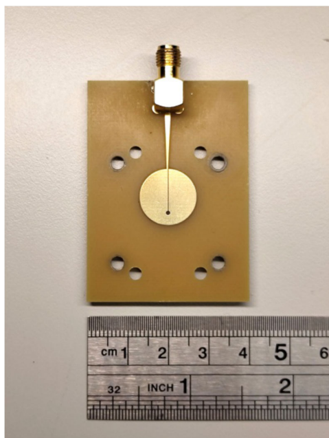
Рисунок 2.6 — Планарная СВЧ антенна на частоту 2,8 ГГц для регистрации ОДМР NV-центров в алмазе
