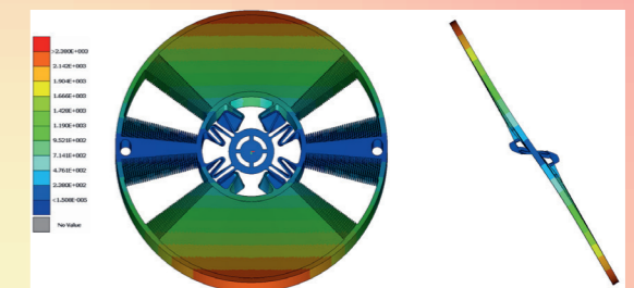
Форма колебаний чувствительного элемента микромеханического вибрационного гироскопа RR-типа
